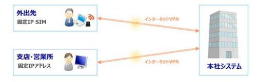
■固定 IP を利用した IP アドレス制限によるクラウドサービスへのアクセスコントロール
